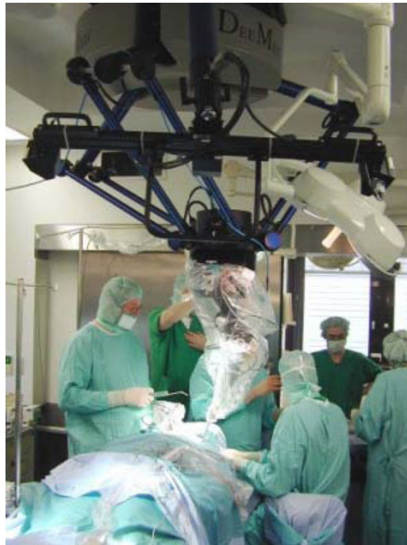
Figura 2.7 El robot Delta en aplicaciones quirúrgicas.
