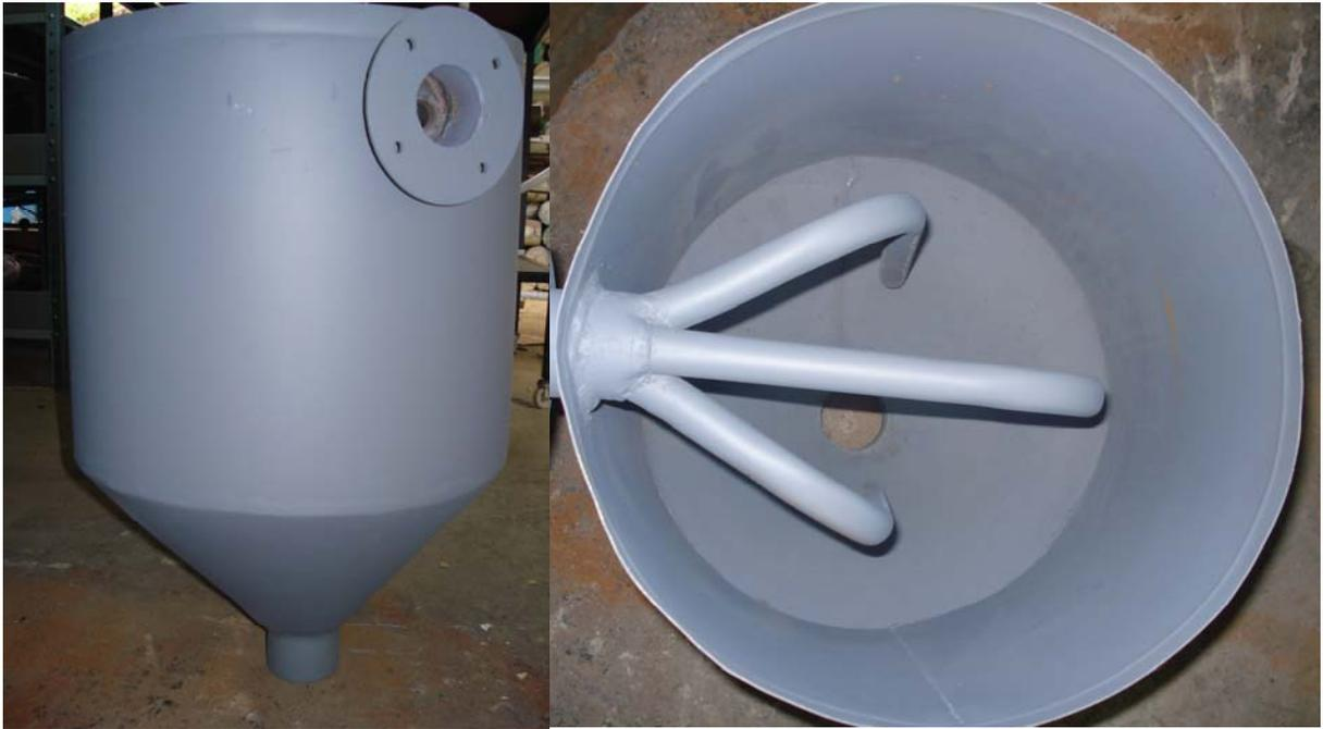
**7.8.2 Ducto de Calentamiento.** Cilindro con puntas cónicas para la entrada de aire y salida del mismo hacia la tolva. (Figura 14)
