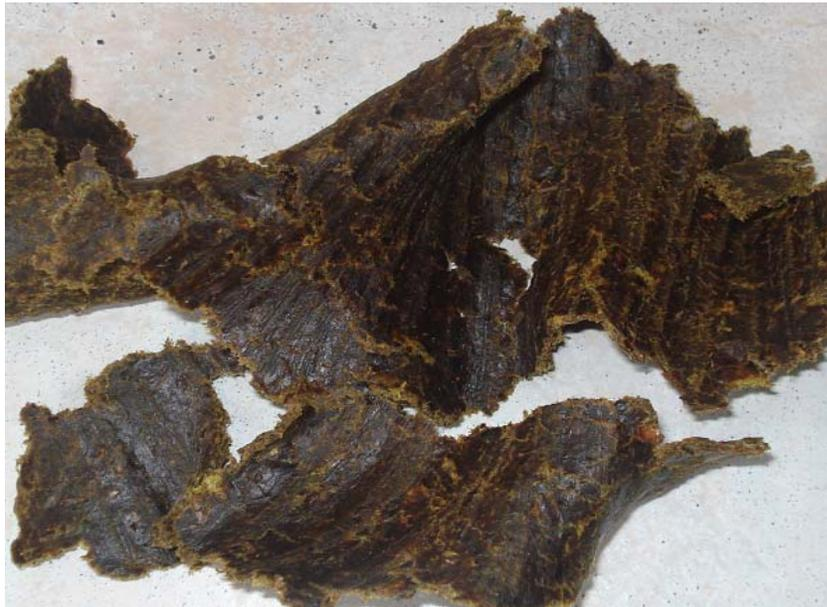
Luego de haberse realizado las pruebas a 3 velocidades, 3 humedades diferentes y temperatura constante, se hace claro ver que a 30 RPM y 6% de humedad es mayor la eficiencia de extracción, (figura 24) además el tiempo que demora en procesar 1000 gramos es menor; la consistencia de la torta o vagazo con los cambios de temperatura y humedad tiene una diferencia física considerable. (Figura 25)
