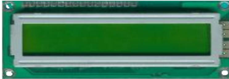
Existen dos formas de enviar datos a un LCD, una manera es utilizando un bus de datos de 8 bits (ver figura 17) y la otra es utilizando uno de 4 bits (ver figura 18), en la conexión de 4 bits se multiplexa el bus enviando primero los 4 bits más significativos del carácter ASCII y luego los menos significativos, esto se realiza mediante programación, cabe resaltar que en la conexión circuital solo se conectan los 4 bits más significativos como se muestra en la figura 18.
