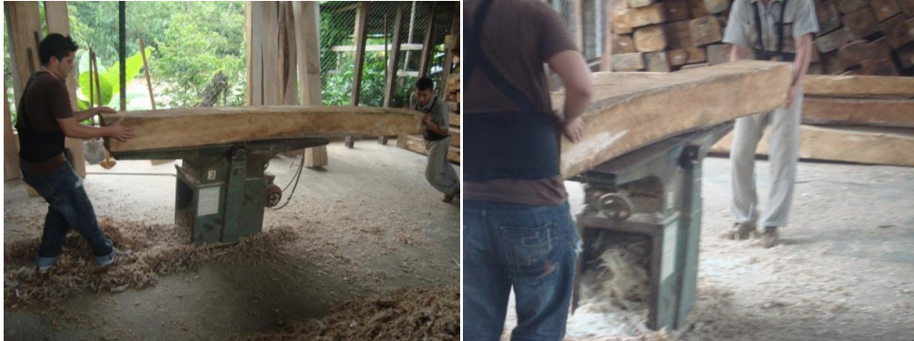
Fotografía 4. Proceso planeo de bloques.
