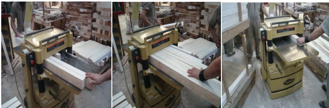
Fotografía 12. Proceso de cepillado.
