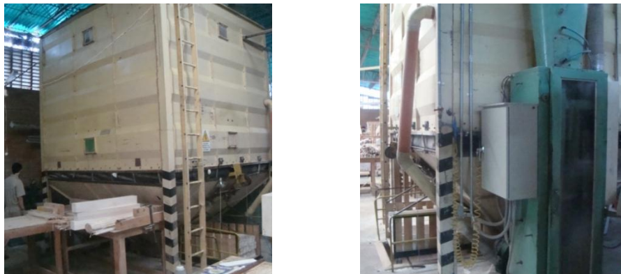
Fotografía 20. Sistema central de succión de polvo.
