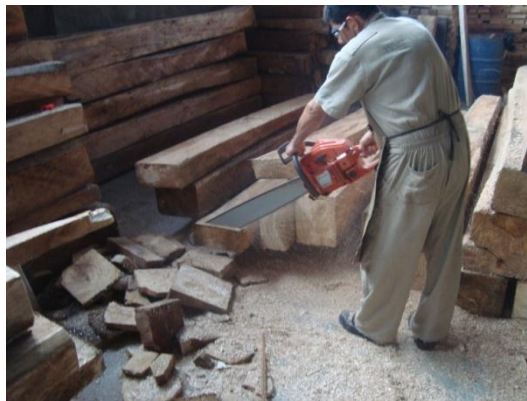
Fotografía 3. Proceso despunte de bloques.
