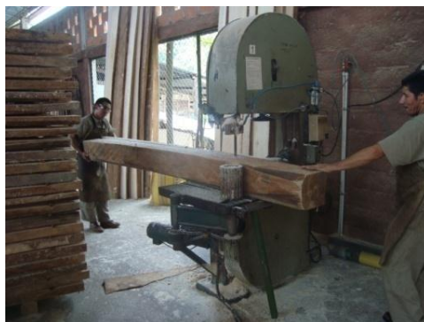
Fotografía 5. Proceso de Reaserrado.
