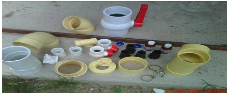
Figura 43. Tubería y accesorios en PVC.
