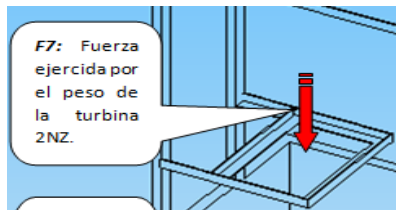
Figura 49. Análisis para el soporte de la turbina Turgo.
