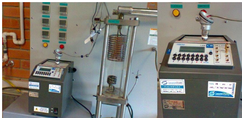
Figura 6. Banco seco de calibración de RTD's
