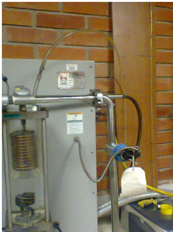
Figura 8. Tubo en U usado en la calibración del Presostato
