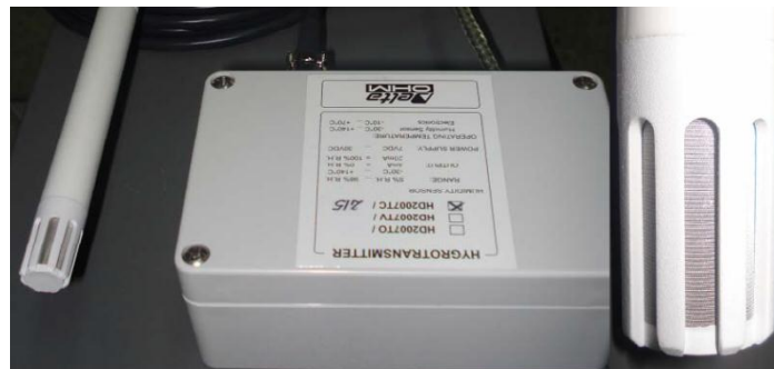
Figura 13: Sensor de Humedad [15]
