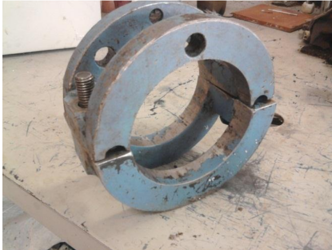
Figura 5: Bridas de Ajuste [17]
