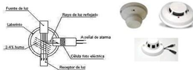
Figura 13. Detector fotoeléctrico de humo (composición interna). 11 Y sensores de humo usados comúnmente en PROTECOM LTDA. (Vista externa). 12
