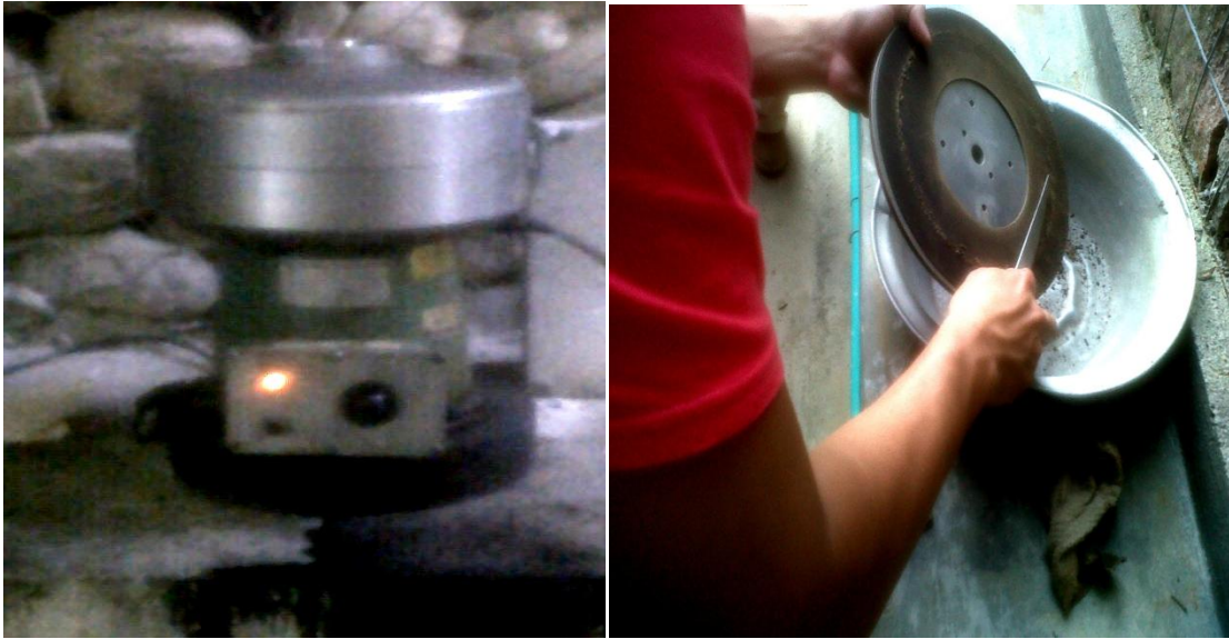
Se muestra el ensayo de contenido de asfalto y como se debe recuperar el material retenido en el filtro.
