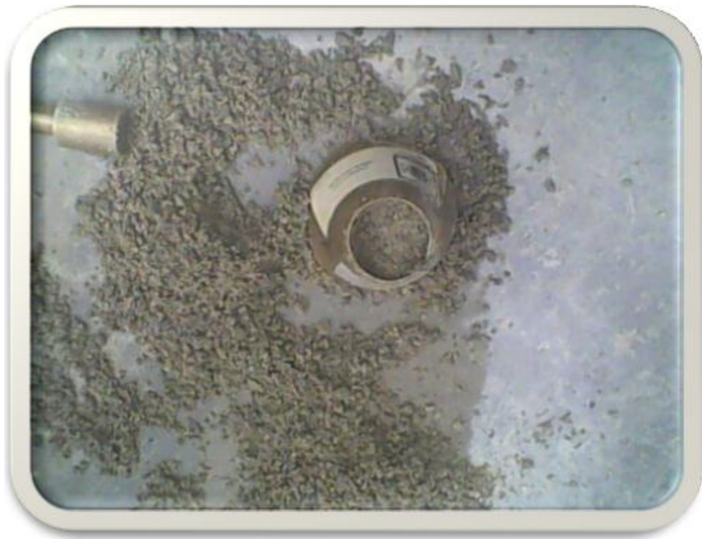
Figura 24. Prueba de Cono
