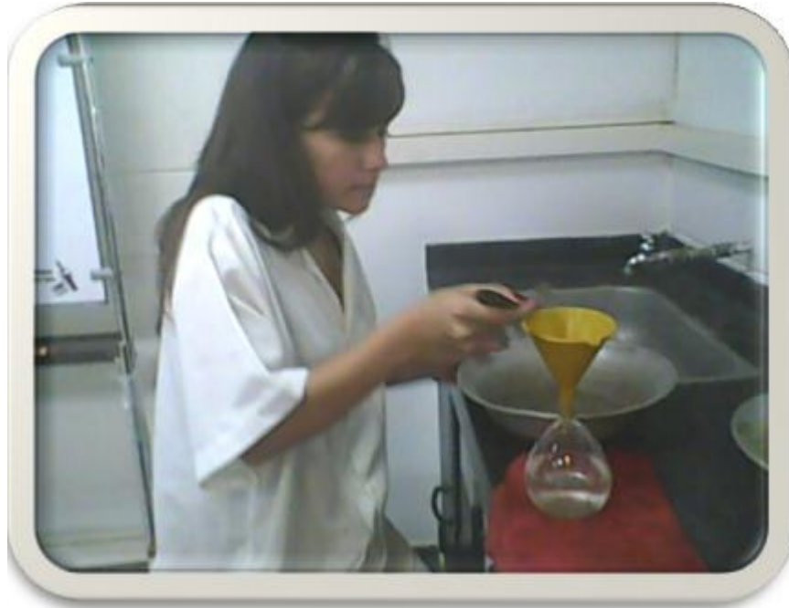
Figura 25. Introducción del material al Picnómetro
