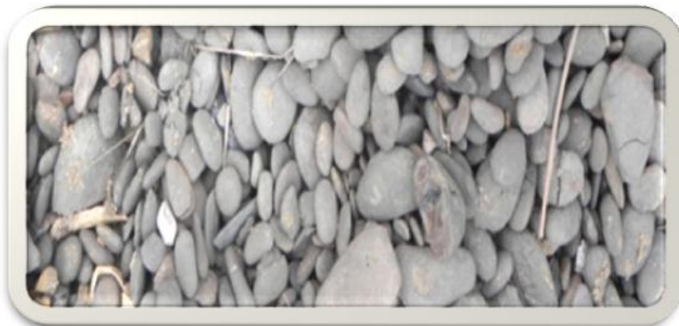
Figura 47. Material primario con partículas orgánicas (trituradora Avendaño Sáenz)
