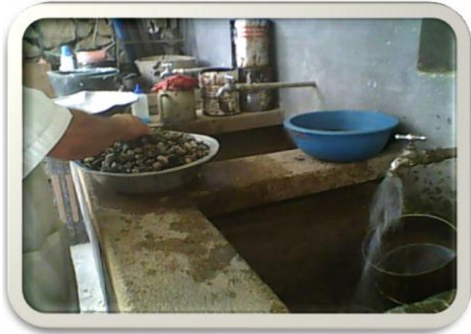
Figura 20. Lavado Material por tamiz N. 200
