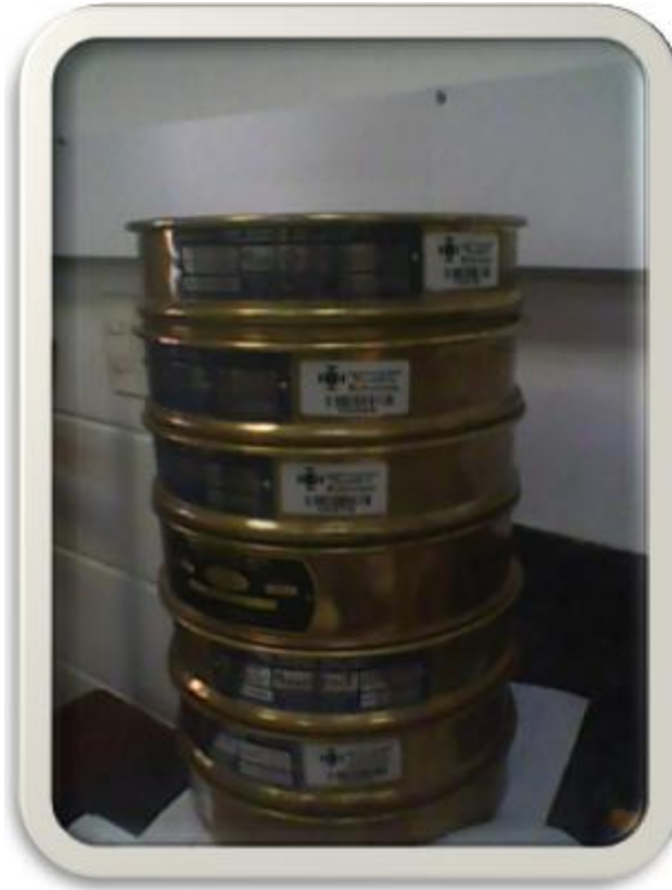
Figura 23. Tamices ubicado de forma descendente para Granulometría
