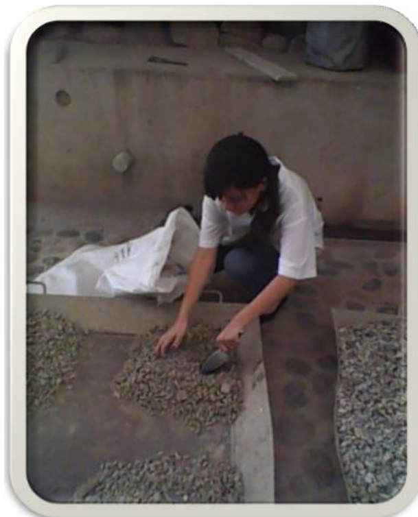
Figura 18. Proceso de cuarteo de la muestra a ensayar
