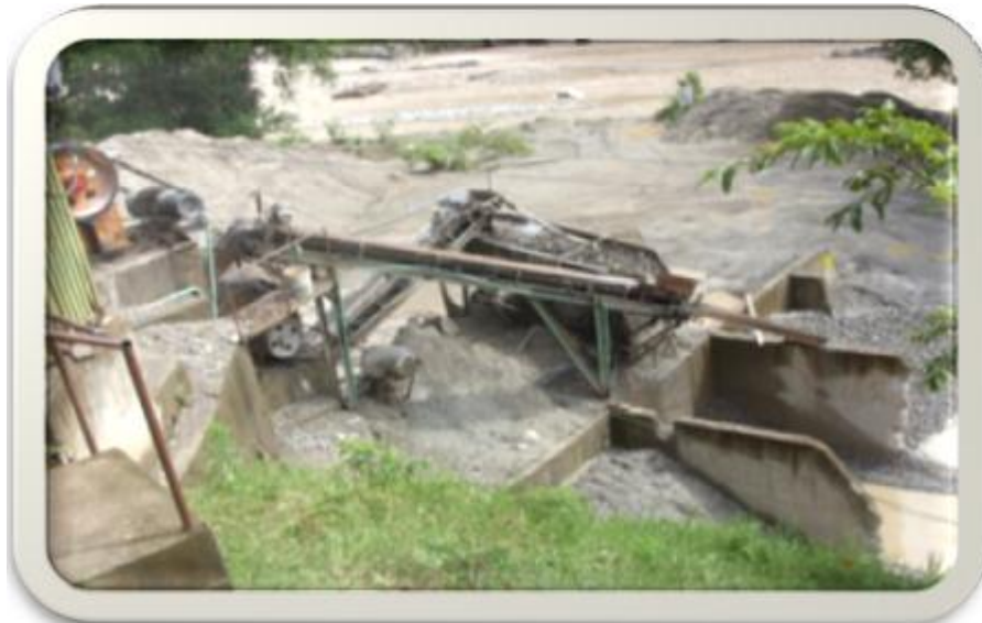
Figura 45. Separación de material (trituradora La Fortuna)
