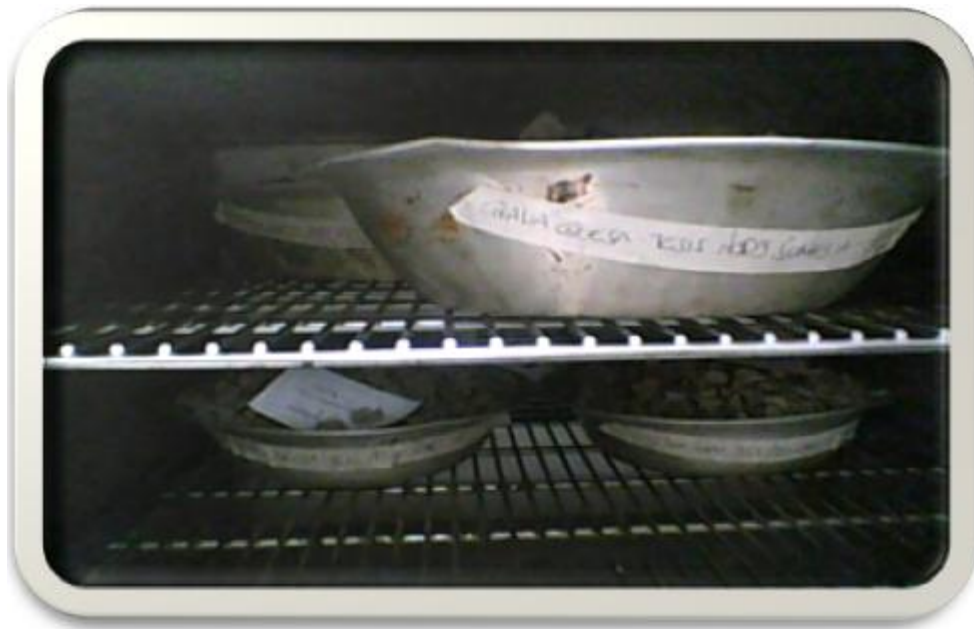
Figura 19. Muestra al horno durante 24 horas
