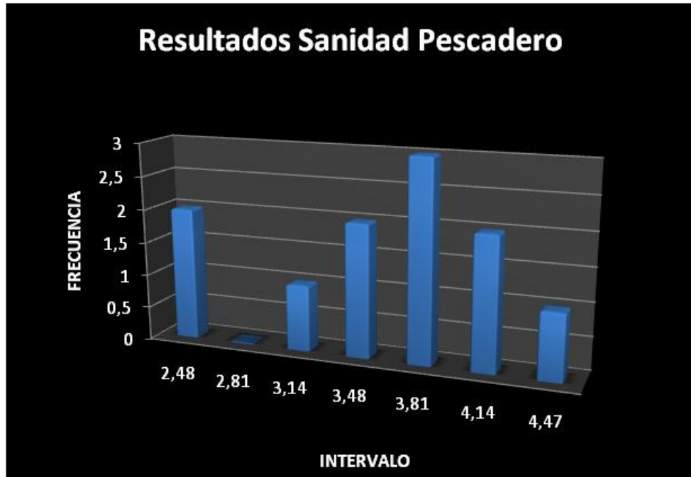
Figura 69. Resultados Sanidad Agregado Fino - Pescadero
