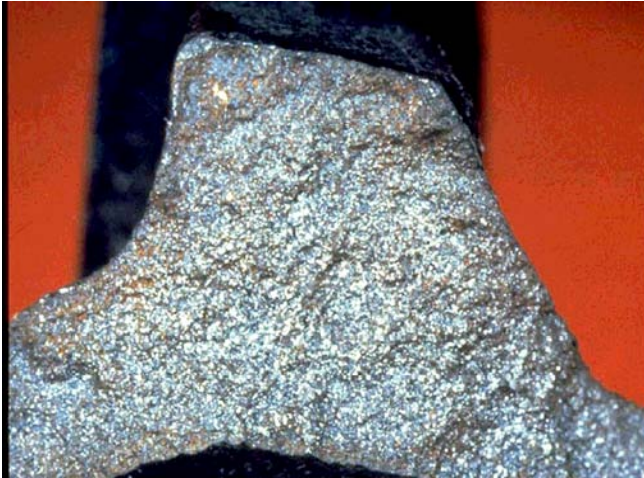
18 -- Esta pieza de acero labrado también recibió un golpe y se rompió (carga por impacto y fractura frágil). Noten que los chevrones son visibles e indican el punto de iniciación. La superficie de ruptura es áspera, brillante y centelleante.
