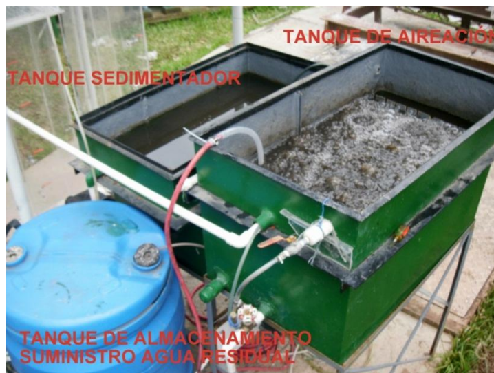
Figura 6. Montaje del sistema de lodos activados escala laboratorio.
