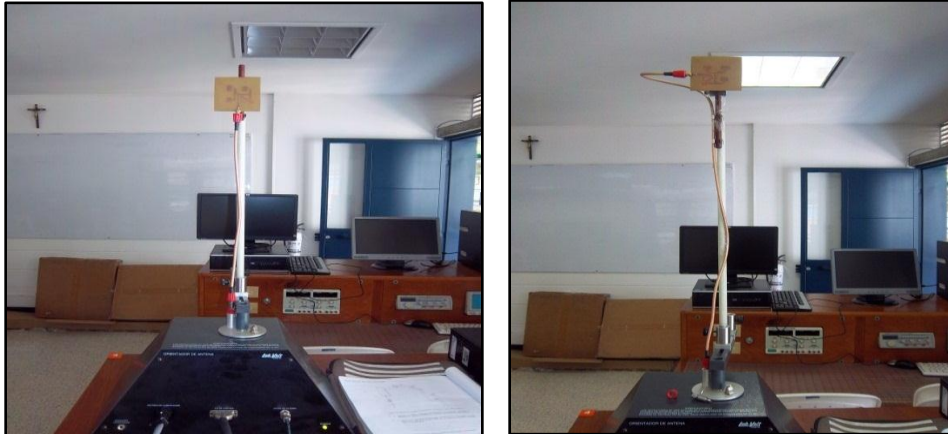
Figura 28 Pruebas de la antena 3. a) Plano H. b) Plano E
