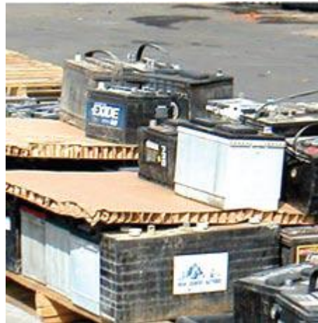
Figura 6. Embalaje de baterías usadas Plomo ácido sobre pallets.
