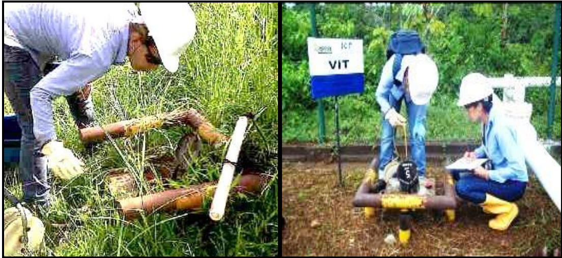
Fotografía 4. Pruebas slug en campo.
