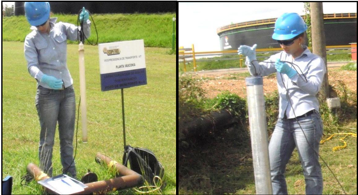
Fotografía 6. Pruebas slug en campo.
