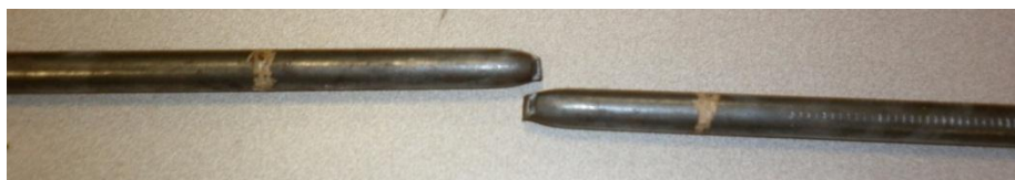
Ilustración 50. Eje sometido a ensayo de tracción
