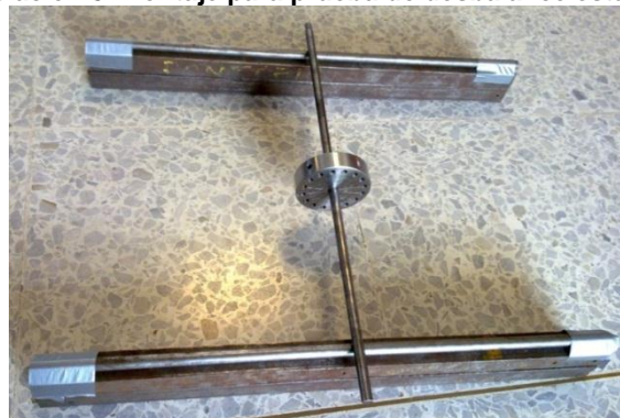
Ilustración 8. Montaje para prueba de desbalance estático
