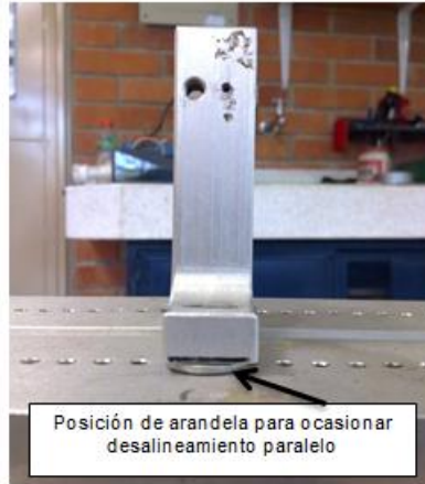
Ilustración 21. Montaje para condición de desalineamiento en rotor kit
