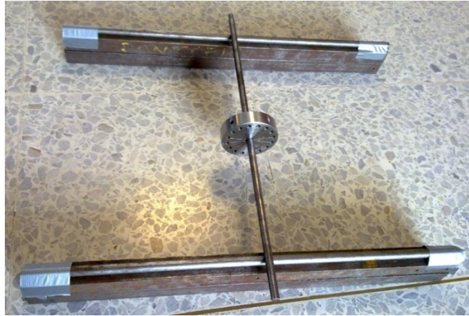
Ilustración 33. Montaje para prueba de desbalance estático
