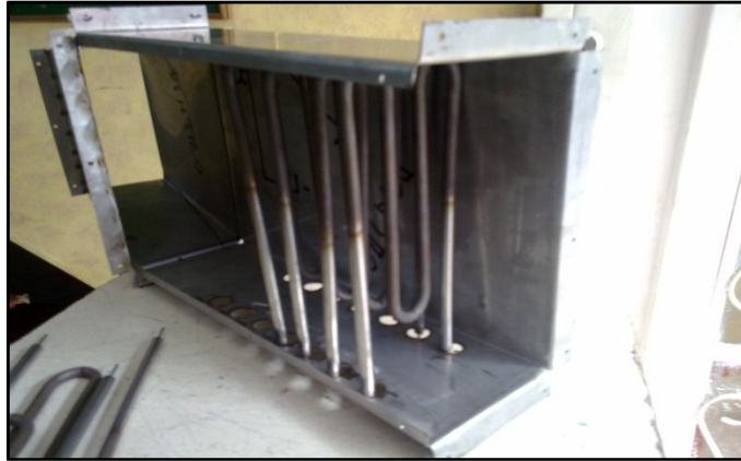
Figura 22 : Ducto de descarga abierto con las resistencias.
