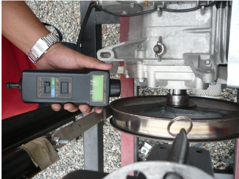
Figura 44. Medición de velocidad con el tacómetro óptico
