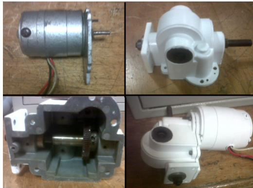
Figura 26: Acondicionamiento del motor-reductor. Fuente autor
