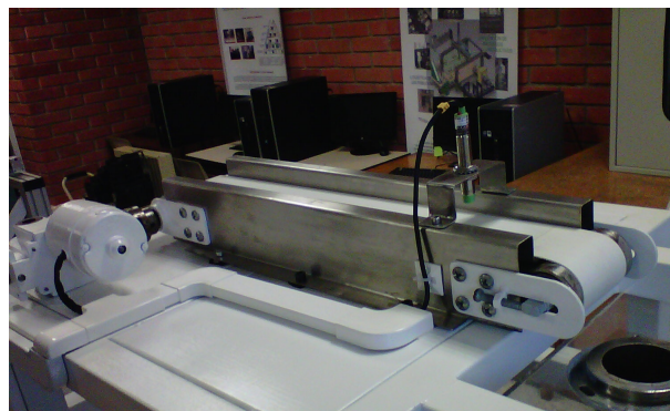
Figura 25: Banda transportadora 1. Fuente autor
