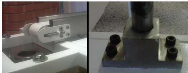
Figura 40: Sistemas de unión no permanente empleados en el prototipo 2. Fuente autor
