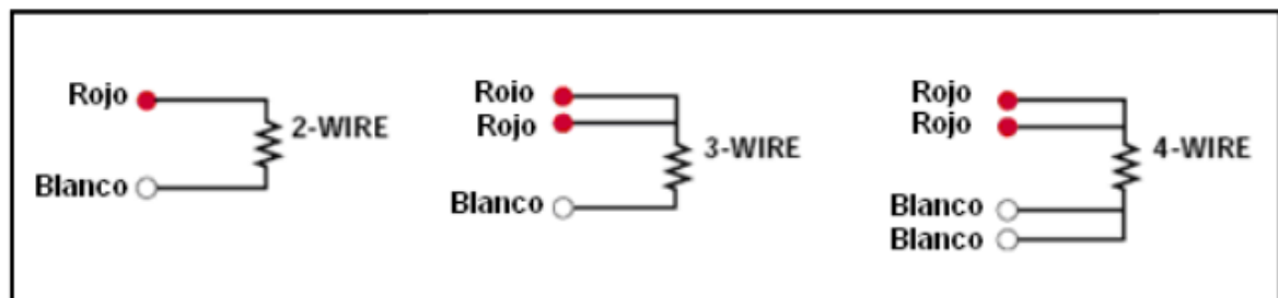
Figura 11. Terminales de un termómetro de resistencia.
