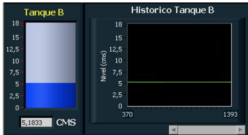
Figura 54. Panel de monitoreo del nivel en el tanque B de la planta
