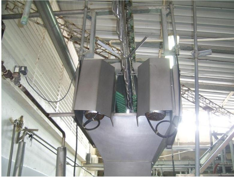
Figura 28. Descolgador automático de patas de la planta
