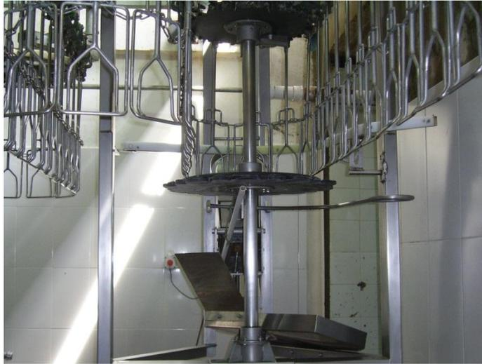
Figura 27. Cortadora de patas de la planta
