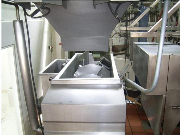
Figura 29. Escaldadora de pata de la planta
