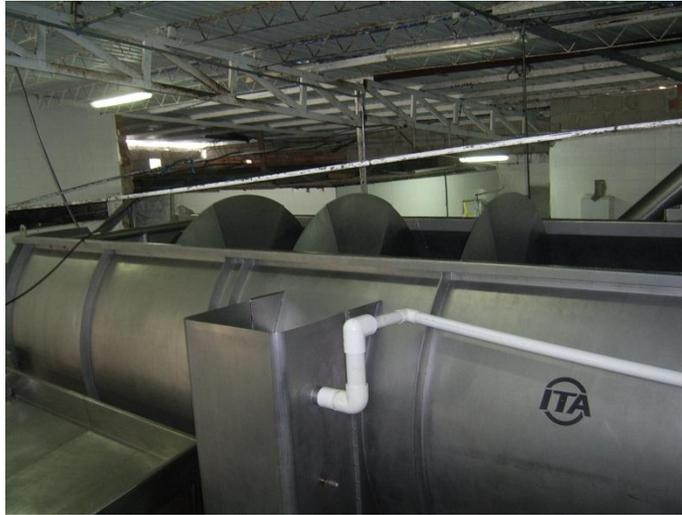
Figura 31. Chiller de tornillo de la planta
