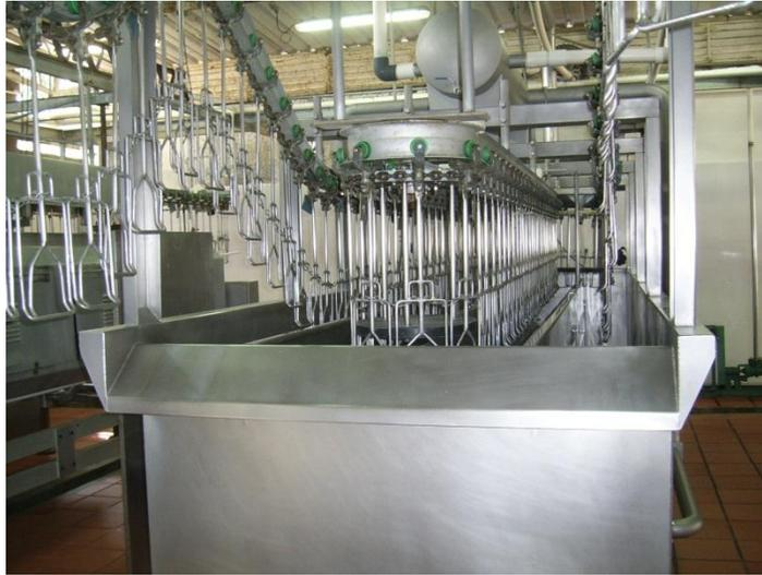
Figura 25. Escaldadora de cuatro pasos de la planta
