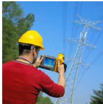
Figura 30. Inspección termográfica de una línea de alta tensión
