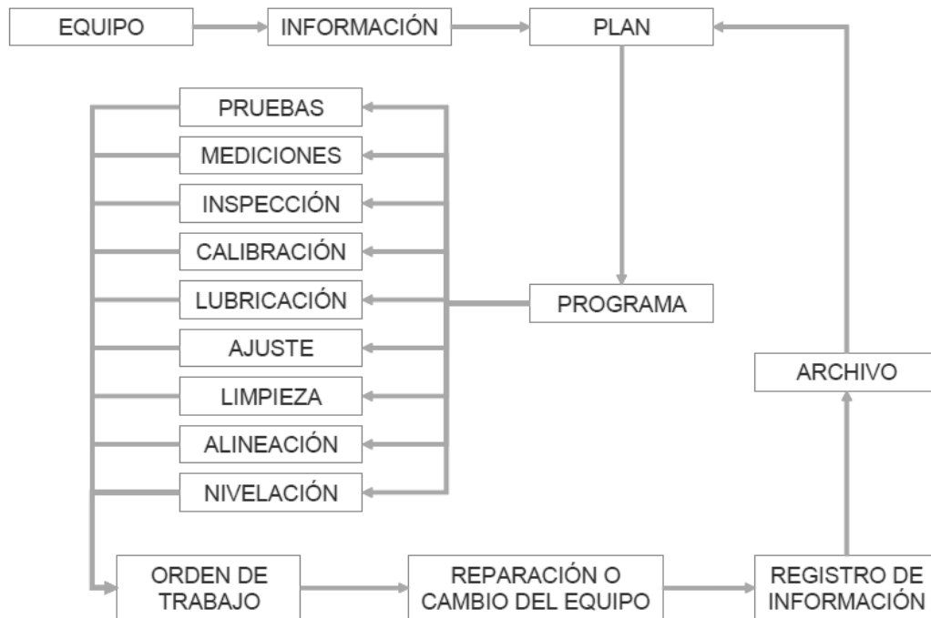
Figura 2. Flujo de trabajo en mantenimiento preventivo
