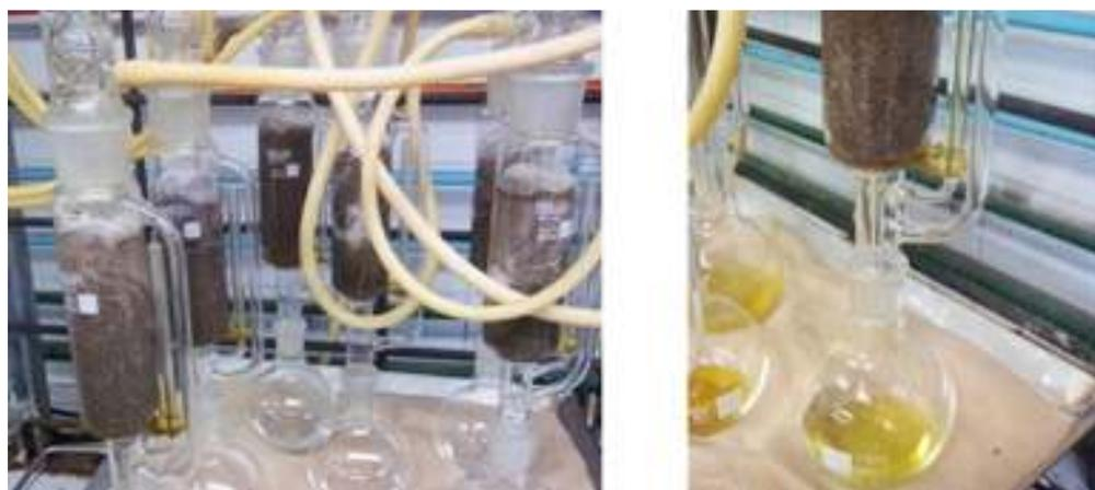
**Figura 12.** Proceso de desengrasado de Torta de Palmiste
