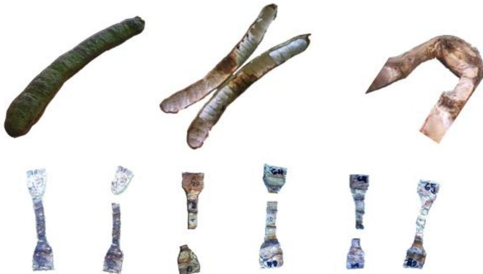
*Figura 15. Probetas para el ensayo de tensión*
