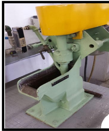
Figura 8. Celda de flotación
