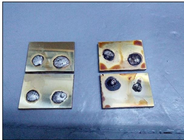
Ilustración 20. Gotas formadas con aleación hipoeutéctica (izquierda) e hipereutéctica (derecha).
