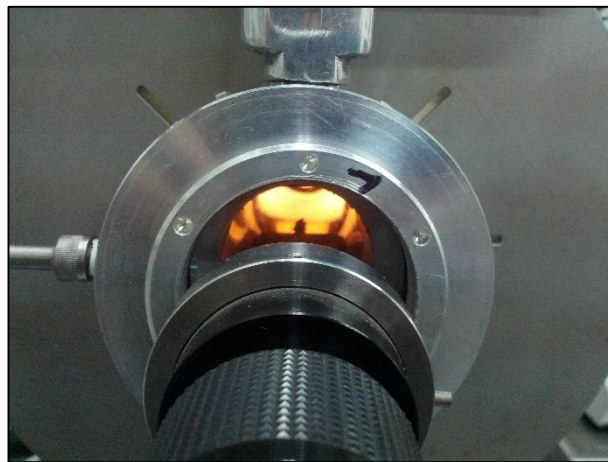
Ilustración 12. Recinto sellado de medición con atmósfera controlada.
