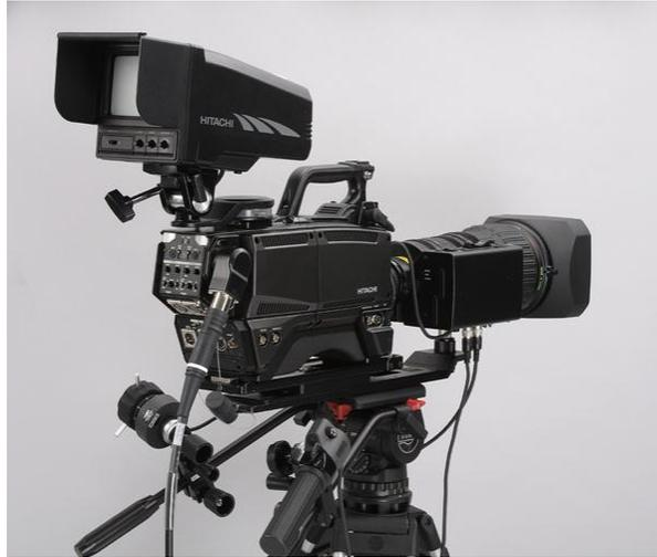
**Figura 14. Cámara Triaxial**
