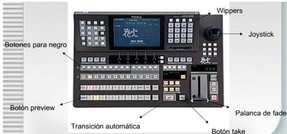
**Figura 7. Partes Básicas de un Switcher [14]**
