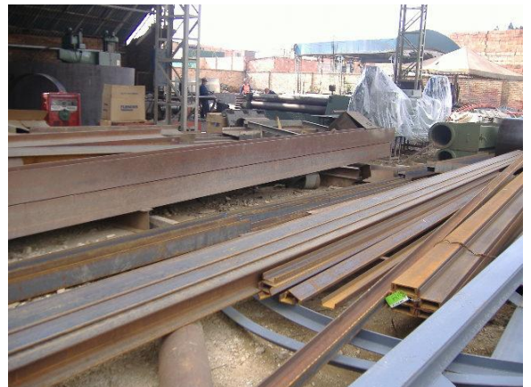
Fig. 17 Almacenamiento de vigas en I y H
