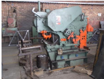
Fig. 3 Cizalla Múltiple Marca FICEP
