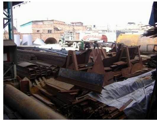
Fig. 32 Almacenamiento de Vigas, Rieles, Canales y Ángulos
