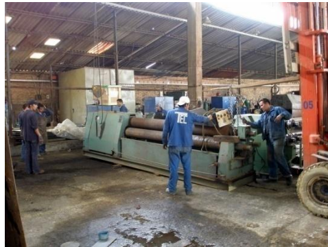
Fig. 47 Traslado y Ubicación de la Enrolladora
