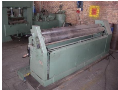
Fig. 6 Enrolladora marca FACCIN WATER
