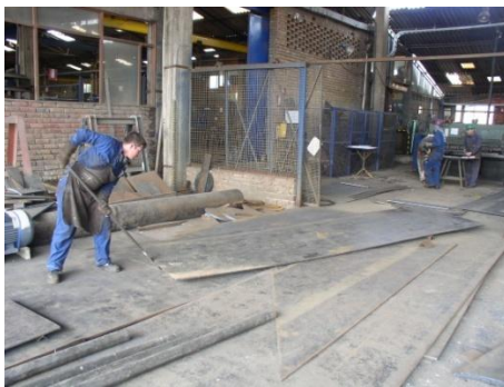
Fig. 27-A Uso de Una Barra para el movimiento de Material
