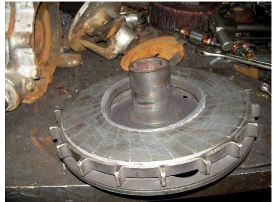
Fig. 34 Rotor del Motor del Polipasto Marca NIPPON
