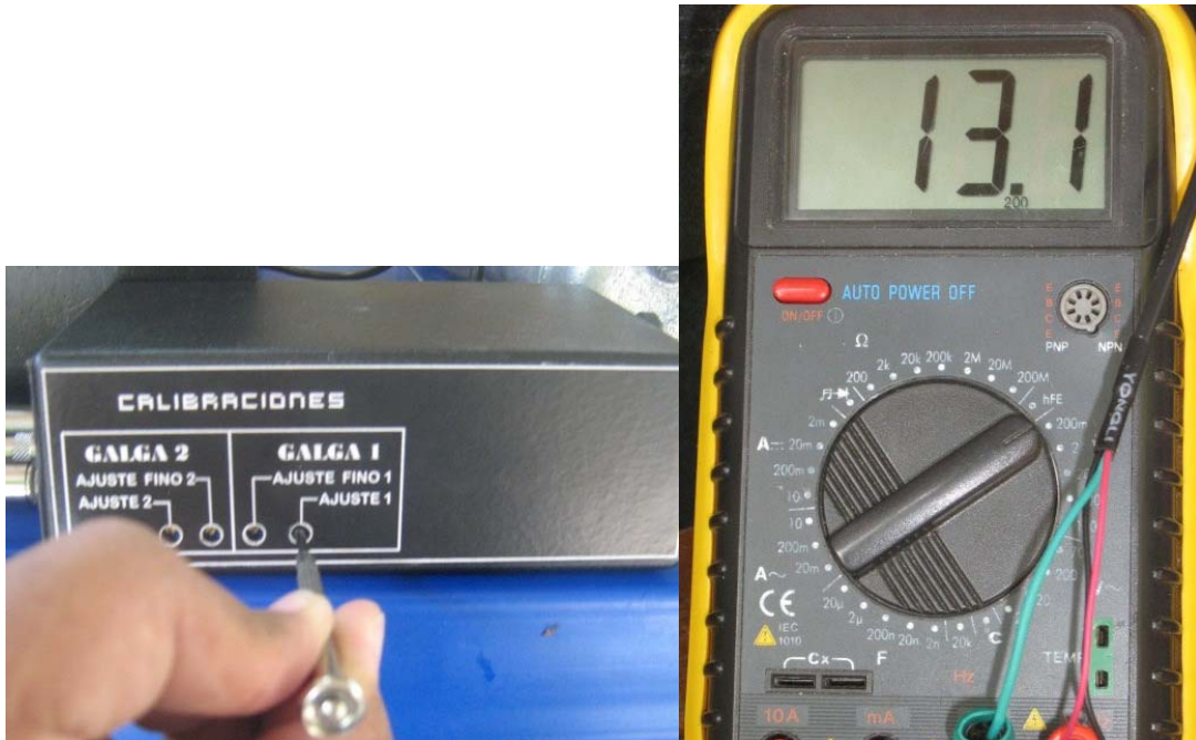
Foto 11. Calibración con ajuste grueso y escala de multímetro. BELTRÁN, Carlos – FAJARDO, Paola. Febrero 2008.
