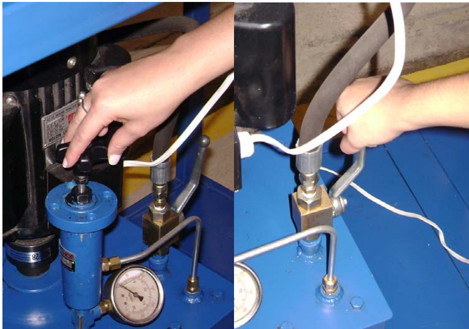
Foto 4. Válvula limitadora de presión (izq.) y válvula de compuerta (der.). BELTRÁN, Carlos – FAJARDO Paola. Febrero de 2008.
