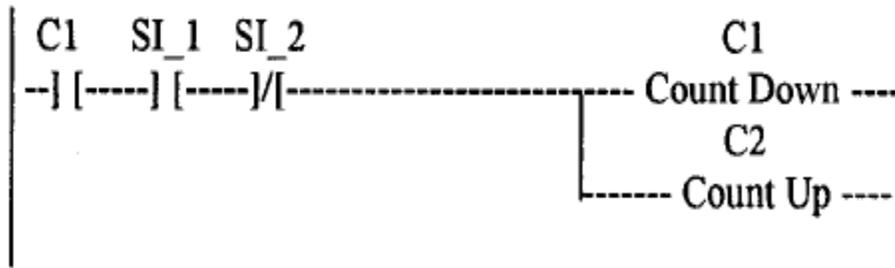
**Figura 10.** Diagrama de Lógica de escalera para el control de red de petri de la Figura 9. [31]
