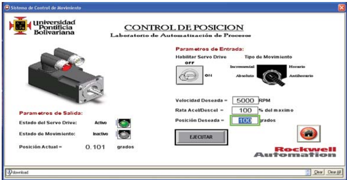
Figura 92. Ejecución del Control de Posición. [28]
