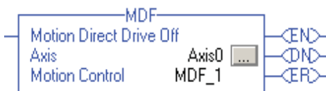
Ejemplo de lógica de escalera de MDF
