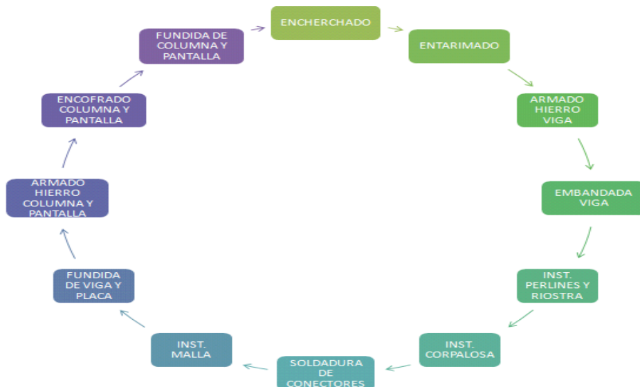
Figura 50. Ciclo constructivo entre placa.
