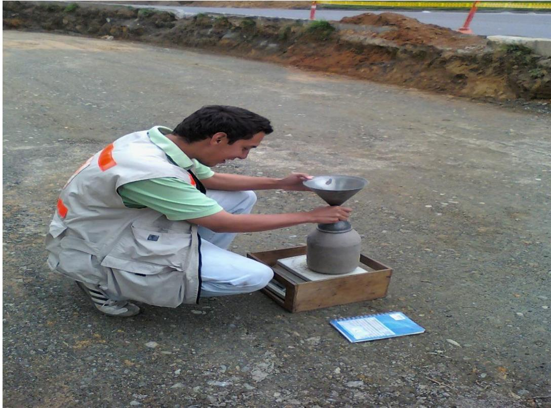
Figura 25. Toma de densidades con el metodo del cono de arena PR 20+020
