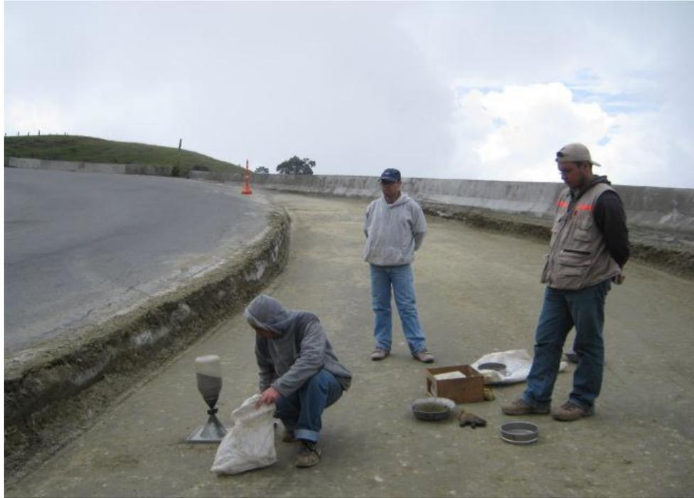
Figura 26. Toma de densidades con el metodo del cono de arena PR 26+150
