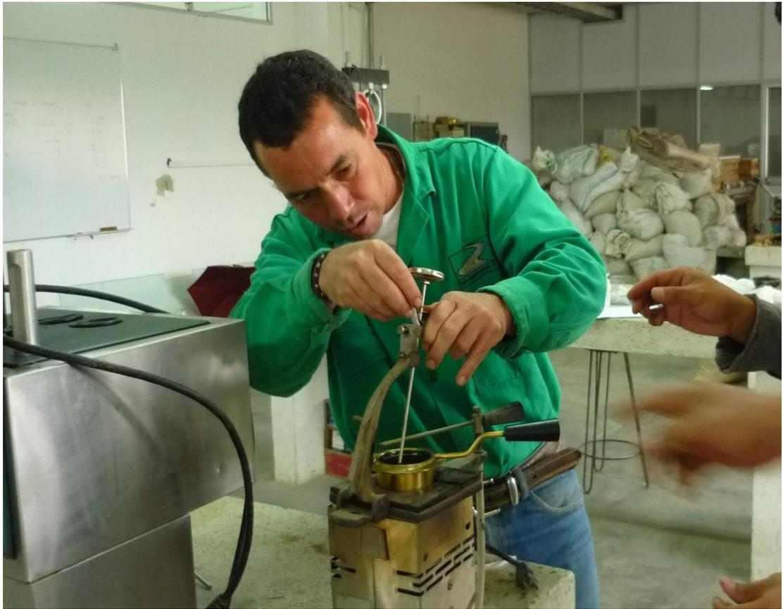
Figura 41. Ensayo de punto de ignición y punto de llama
