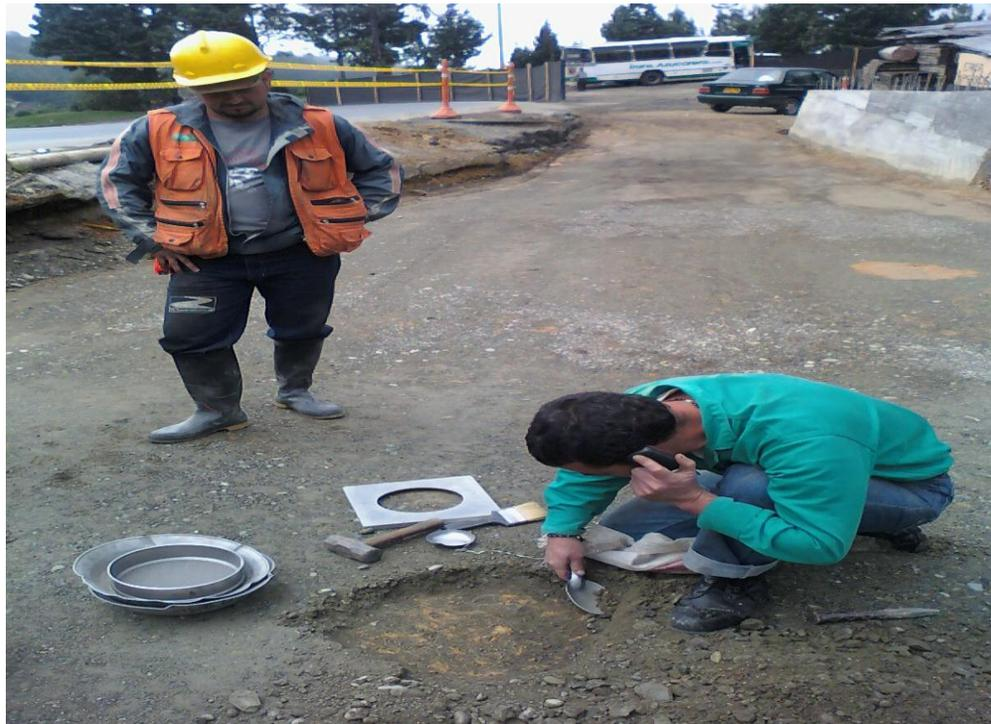
Figura 27. Toma de densidades con el metodo del cono de arena PR 20+050
