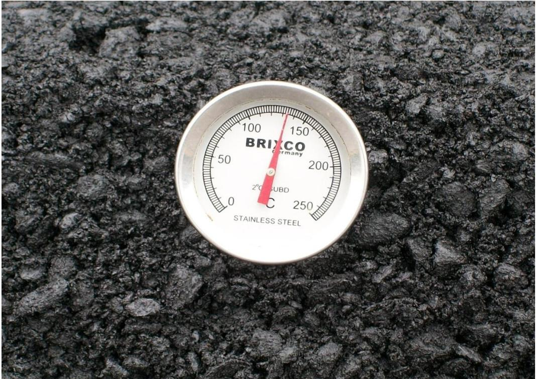
Figura 32. Temperatura de la mezcla asfáltica
