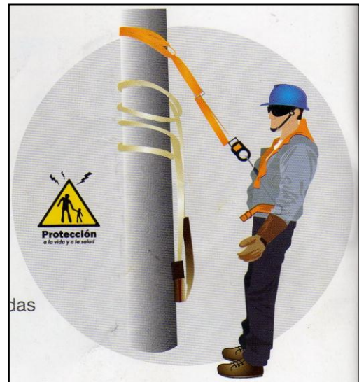
Figura 4. Ascenso a poste con Pretales
