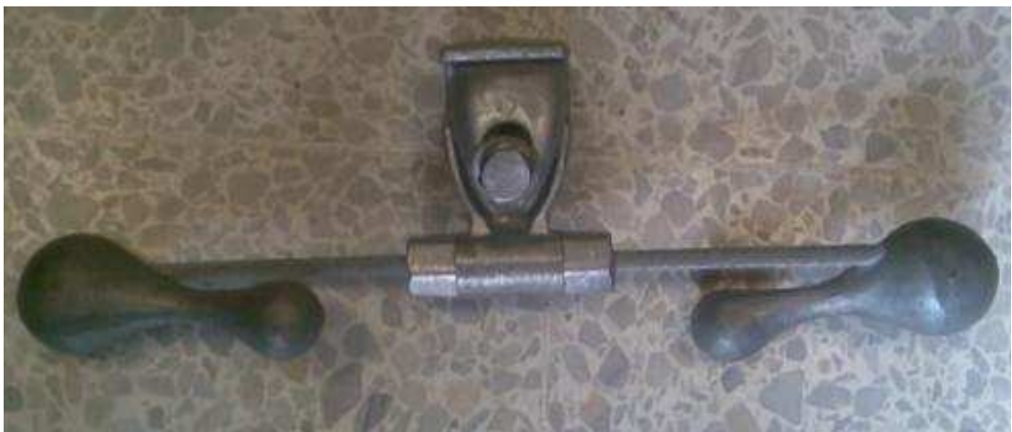
Figura 49. Amortiguador de líneas eléctricas de alta tensión
