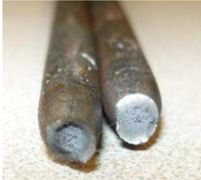
Figura 4, Grupo 1, barra referencia 8, prueba tracción
