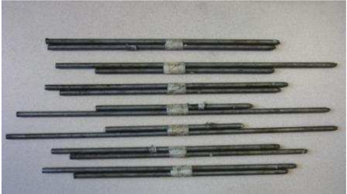
Figura 7, Barras Grupo T, prueba de tracción
