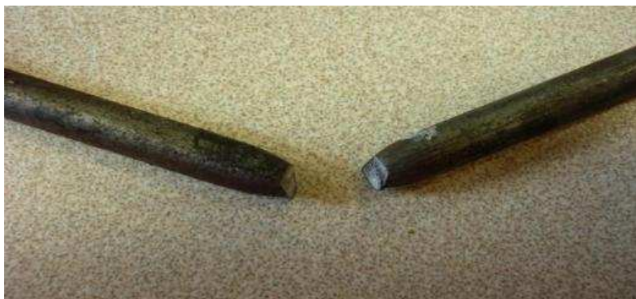
Figura 9, Grupo T, barra referencia 10, prueba tracción
