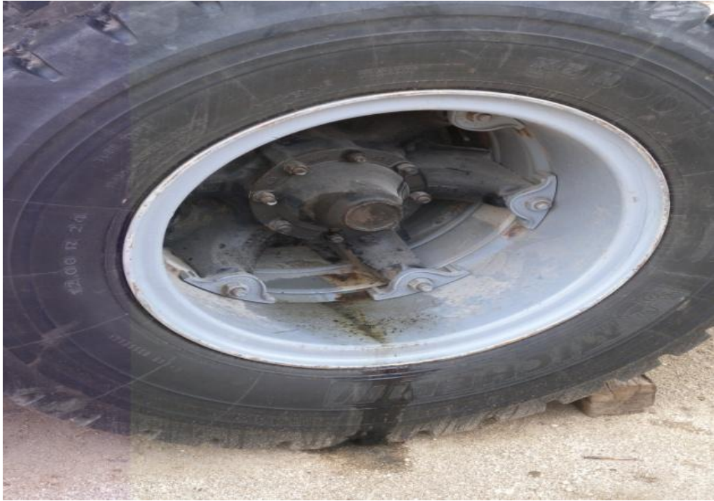
Foto 17. Vertimiento de aceites en llanta de maquinaria
