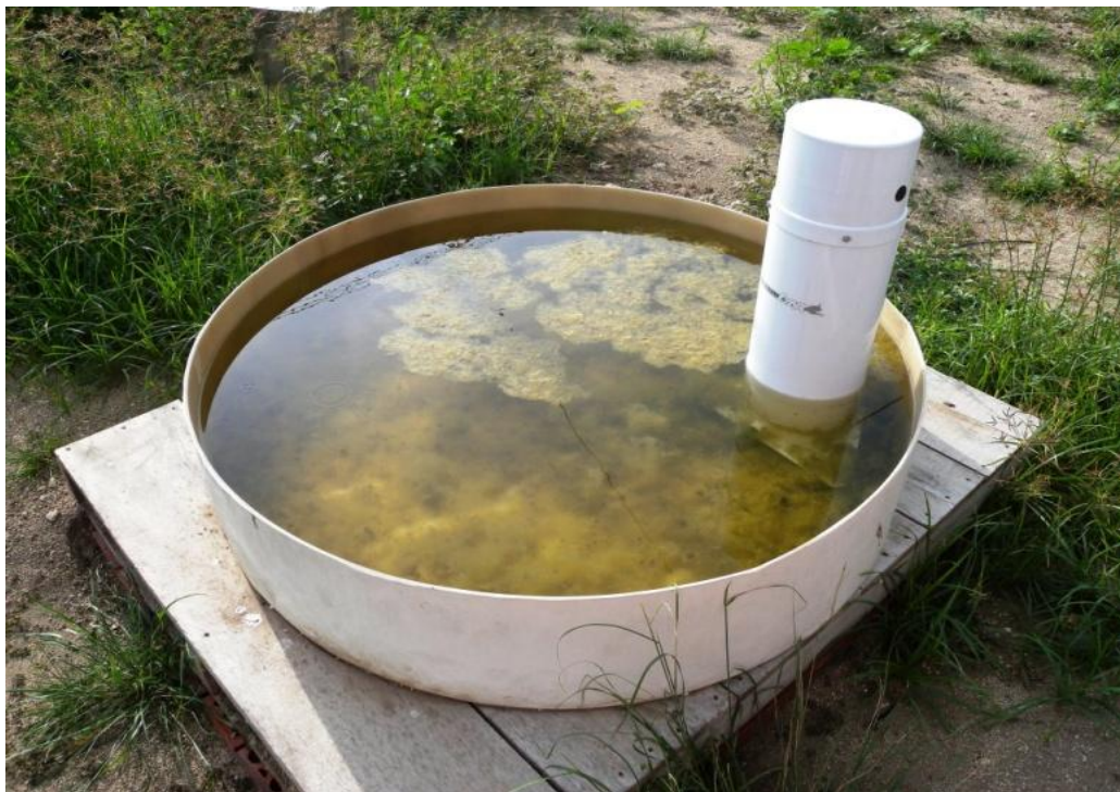
Foto 31: Evaporímetro en mal estado
