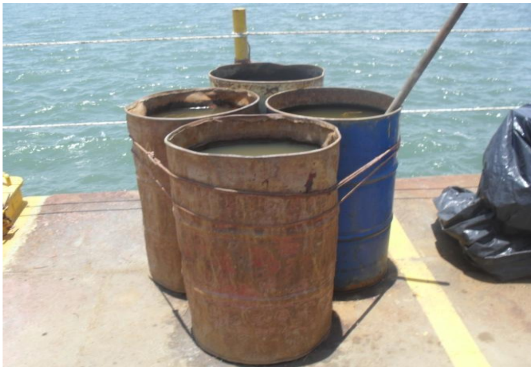
Foto 34: Tanque para lavado de tubería de perforación
