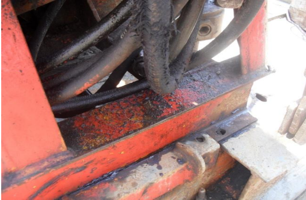
Foto 35: Grasas en equipo de perforación
