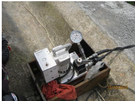
Figura 16. Equipo de Tensionamiento y colocación del gato
