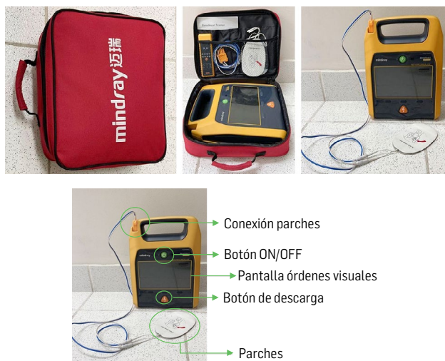
● Figura 4. DEA (Desfibriladores externos automáticos) y sus partes.
