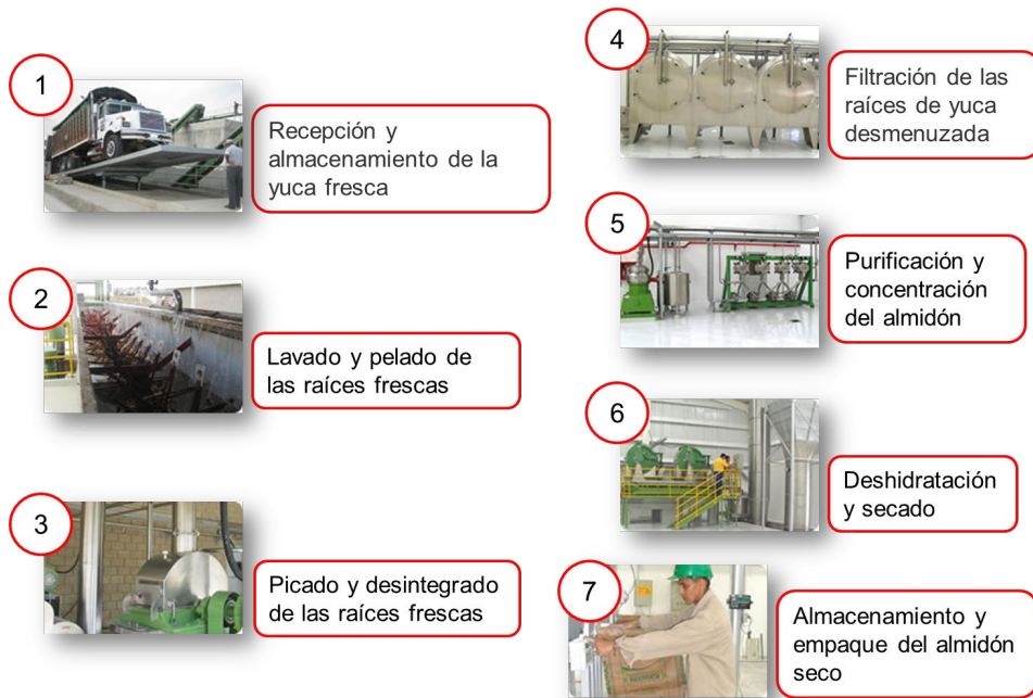
Figura 10. Proceso de elaboración del almidón
