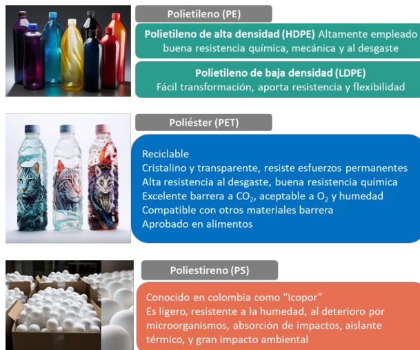
Figura 64. Características de algunos plásticos (PE, PET, PS) empleados en la industria de empaques
