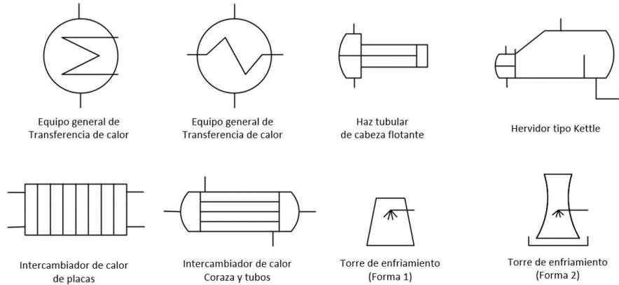
Figura 26. Simbología básica empleada en la representación de intercambiadores de calor
