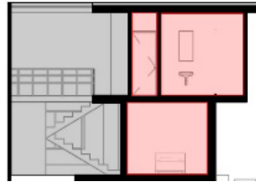
Imagen 54 Sección transversal 2 con espacios “llenos” (contenidos) en rojo y “vacíos” (abiertos) en gris
