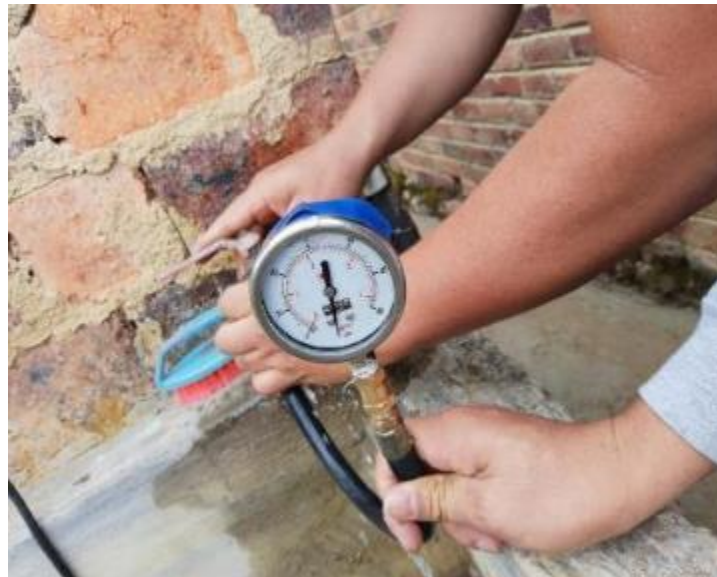
Ilustración 19. Verificación de presiones hidráulicas y posteriores diseños de redes para suministro de aguas.
