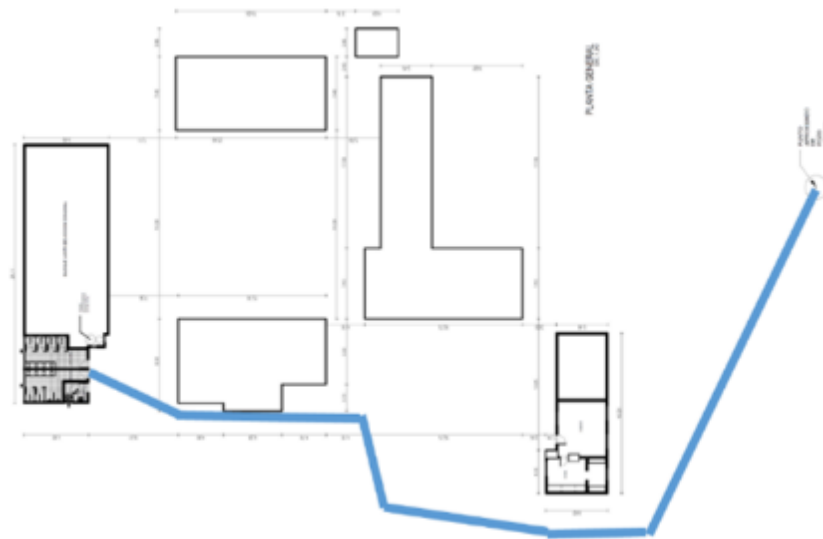
Ilustración 13. Zona de excavación tubería sanitaria hasta pozo séptico según plan proyectado.
