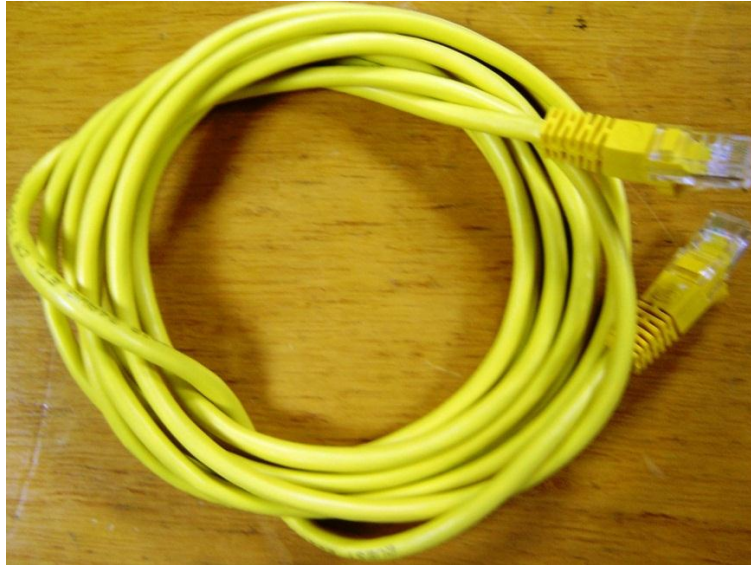
Figura 14. Cable UTP para la interconexión de los módulos
