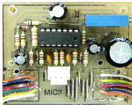
Figura 13. Circuito de captura y transmisión tarjeta final
