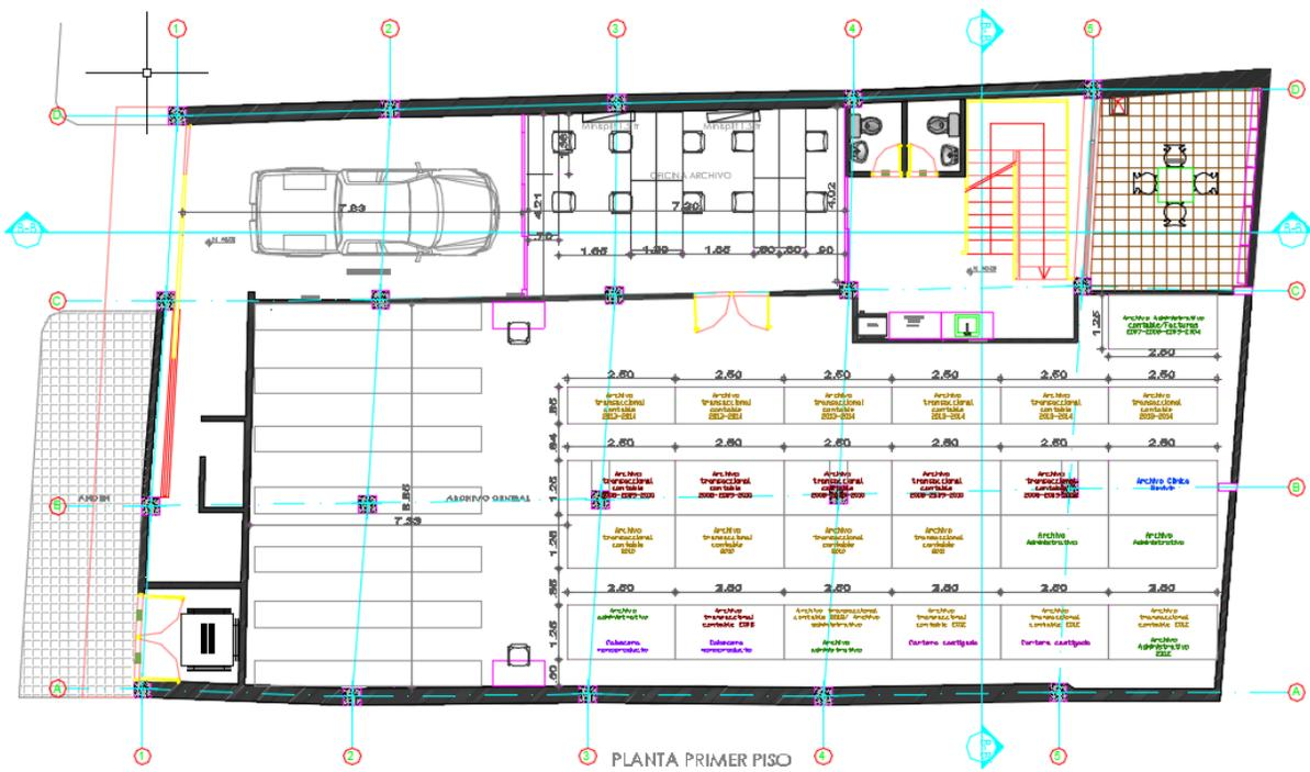
Ilustración 7. Planta primer piso edificio Archivo Central, diseño remodelación oficina.
