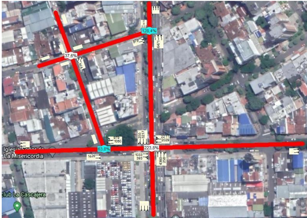
Ilustración 9. Simulación de tráfico en Shyncro 6. Fuente: Autor.
