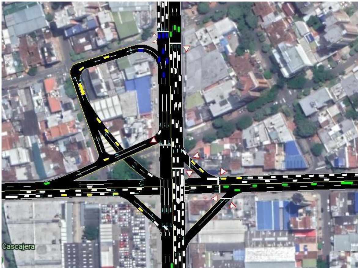
Ilustración 11. Simulación de tráfico en SimTraffic. Primera alternativa. Fuente: Autor.
