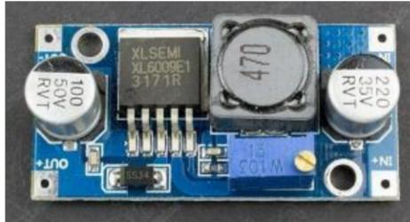
Nota: El convertidor DC-DC es utilizado para regular el voltaje de los motores. Tomado de *Convertidor DC – DC XL6009 tipo Boost* [Imagen] Galindo Mejía & Rodríguez Peláez, 2019.
