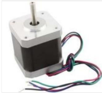
Nota: El motor utilizado para accionar los grados de libertad del brazo robótico. Tomado de *Motor Paso a Paso* [Imagen] Medrano Trujillo, 2020.
