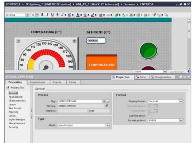
Imagen 22. Configuración Setpoint, visualización de los botones de activación y apagado del sistema, del botón temporizador y indicador de temperatura grafico en el HMI. Fuente: propia.
