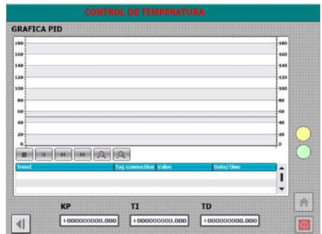
Imagen 37. Pantalla PID del HMI. Fuente: propia
