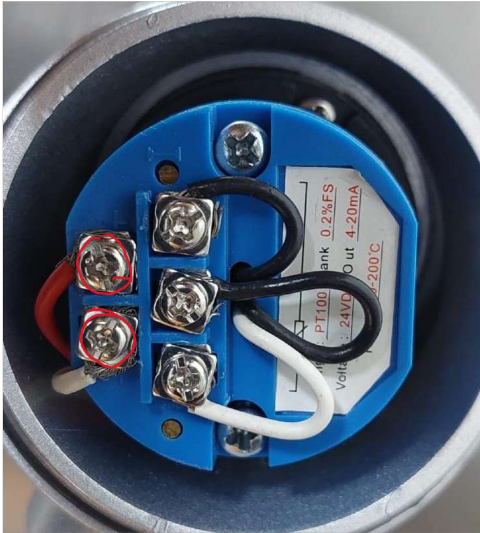
Figura 64. Puntos de medición de la resistencia del sensor RTD. Fuente: propia
