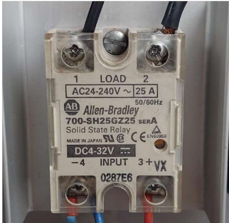
Figura 7. Relé de estado sólido para activar la resistencia eléctrica. Fuente: propia
