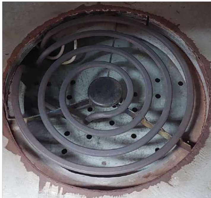
Figura 5. Resistencia eléctrica para parrilla. Fuente: propia
