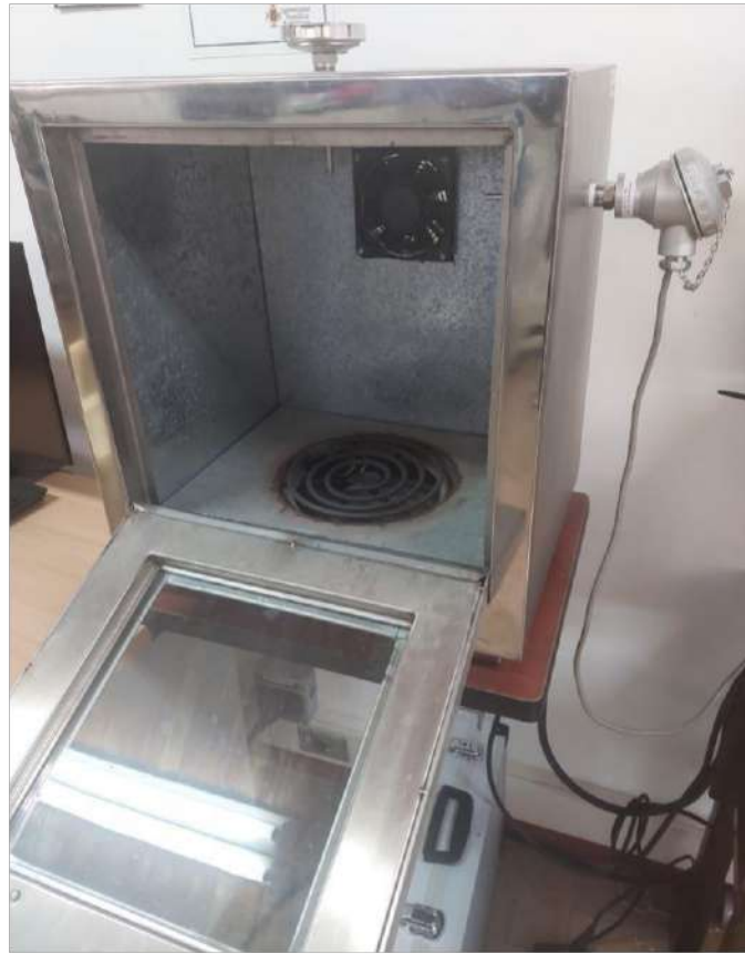
Figura 75. Cámara de calentamiento. Fuente: propia.
