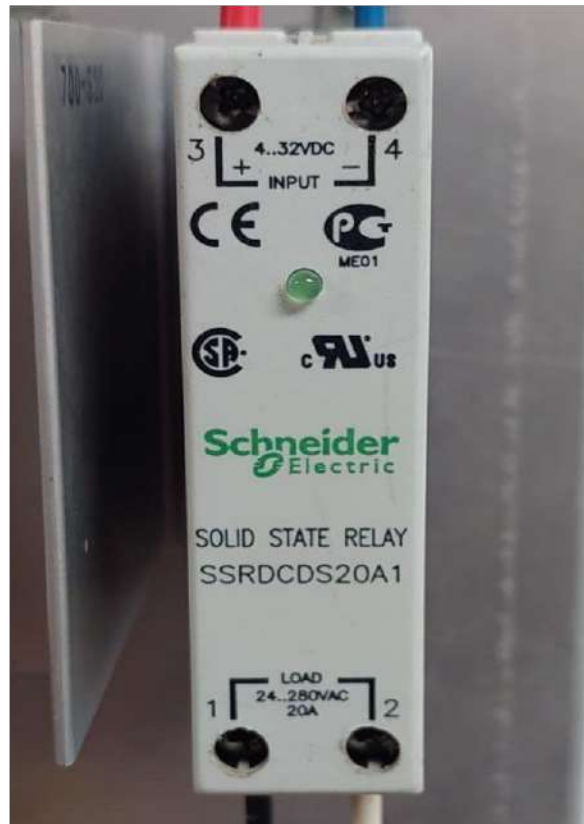
Figura 8. Relé de estado sólido para activar el ventilador. Fuente: propia
