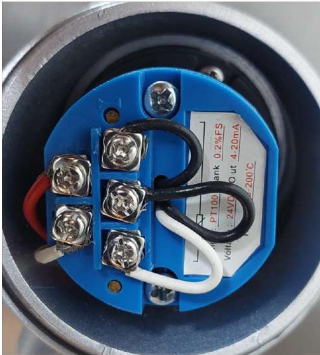
Imagen 3. Conexión del sensor RTD con el transmisor. Fuente: propia.
