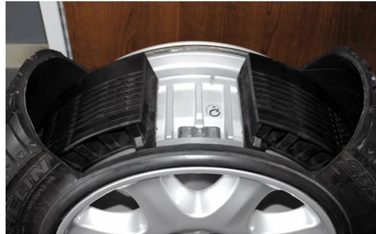
Nota: Interior de Llanta Run Flat donde se puede observar el diseño
