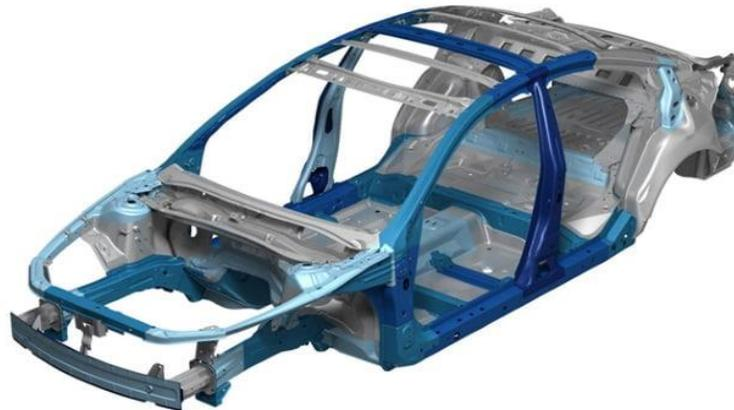
Nota: Ejemplo de chasis tipo monocasco en un vehículo común
