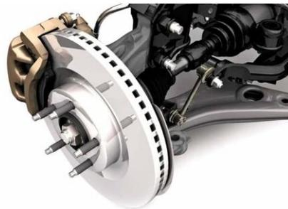
Nota: El diseño abierto del disco permite una mejor disipación del calor generado durante el frenado
