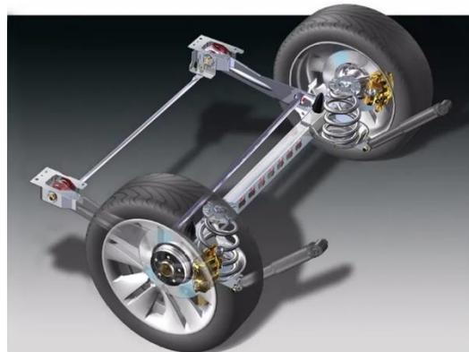
Nota: las vibraciones producidas en una rueda se transmiten a la otra
