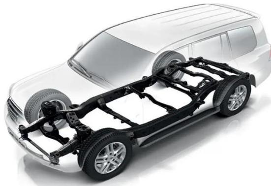
Nota: Ejemplo de chasis de tipo bastidor en un vehículo
