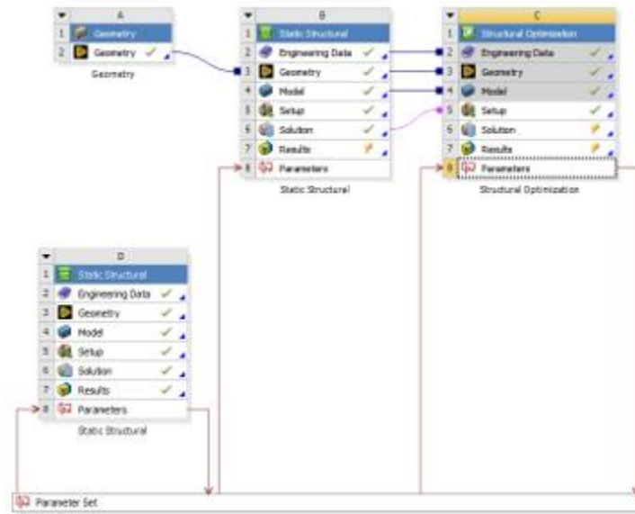
Imagen 42. Esquema de parametrización ANSYS Workbench.
