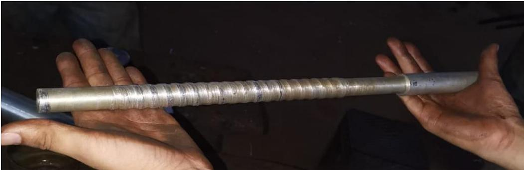
Imagen 23. Prototipo de tornillo sin fin a escala reducida.
