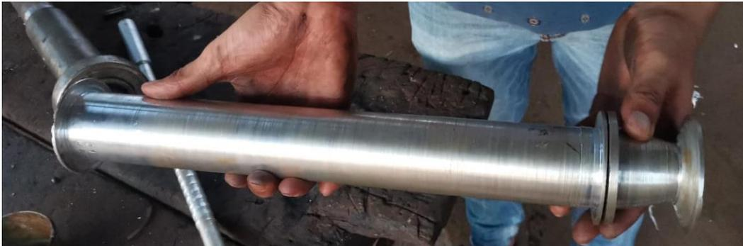
Imagen 21. Prototipo de cubierta y boquilla de descarga a escala reducida.
